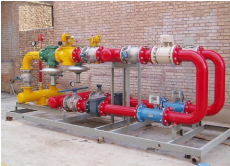
双路燃气调压箱，包括调压器主路部件和副路调压器；所述调压器主路部件与所述副路调压器均具有进气端和出气端；调压器主路部件进气端与副路调压器进气端之间连接有主路进气双路球阀；调压器主路部件出气端与副路调压器出气端之间连接有主路出气双路球阀；所述主路进气双路球阀与所述主路出气双路球阀结构相同，均为双路球阀。双路燃气调压箱的优点在于：本方案的双路燃气调压箱，用于区域性燃气输出压力的控制与调节。本方案采用模块化设计、经标准化优化组合，通过主路进气双路球阀，替代了主路进气法兰球阀、主路进气三通和副路进气
